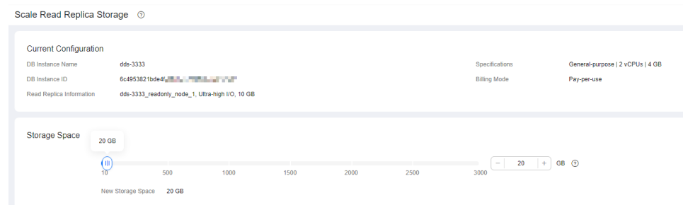
Figura 5-11 Ampliação de uma réplica de leitura
